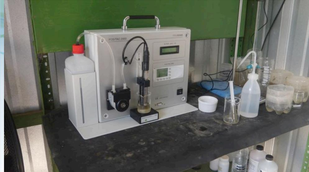
AQUALIMPIA ENGINEERING DISPONE DE SU PROPIO EQUIPO PARA REALIZAR LAS MEDICIONES DE FOS/TAC EN EL BIODIGESTOR. REALIZAMOS ESTAS MEDICIONES EN CUALQUIER PAIS O REGIÓN ESTE UBICADA LA INSTALACIÓN.
