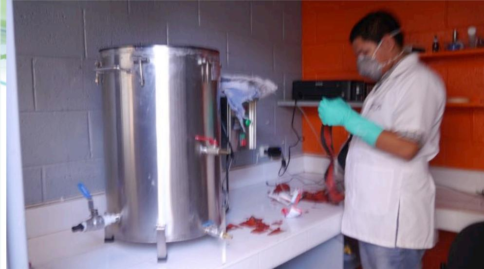
**AQUALIMPIA ENGINEERING E.K.** DISPONE DE UNA PLANTA PILOTO DE LABORATORIO PARA LA REALIZACIÓN DE ENSAYOS DE BIOMASA PARA DETERMINAR LA PRODUCCIÓN DE BIOGÁS EN VOLUMEN Y LA CONCENTRACIÓN DE METANO (%). SE TRATA DE UN EQUIPO CON ACCESORIOS DE MEDICIÓN Y CONTROL DESARROLLADOS Y FABRICADOS ÍNTEGRAMENTE EN ALEMANIA Y DE MARCAS RECONOCIDAS. EL LABORATORIO FUNCIONA EN SISTEMA BATCH; UNA CARGA UN PROCESO.
