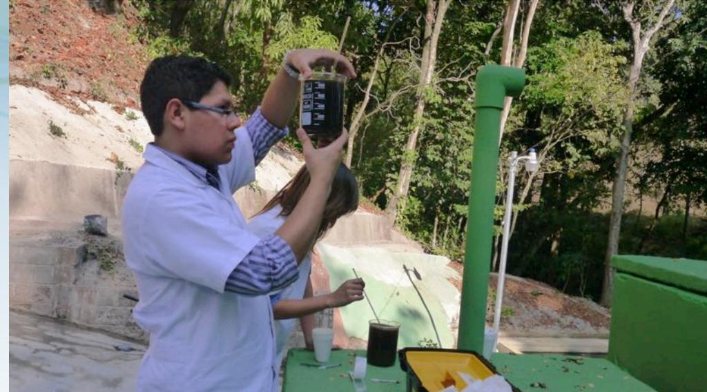
**AQUALIMPIA ENGINEERING** REALIZA MEDICIONES IN SITU PARA DETERMINAR LA EFICIENCIA DE DEGRADACIÓN DE BIODIGESTORES Y PLANTAS DE DEPURACIÓN DE AGUAS RESIDUALES. REALIZAMOS MEDICIONES DE DQO, DBO, SST, SV, ETC. Y PREPARAMOS RECOMENDACIONES PARA MEJORAR LA EFICIENCIA DE TRATAMIENTO Y DEGRADACIÓN.
